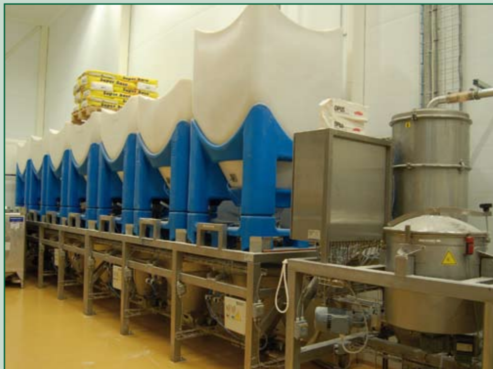
Opstelling van zeven van de acht ibc's met daaronder de doseerapparatuur.
