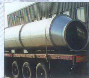
Kanaalwerk verlopend van rond 1800 mm naar rond 800 mm.
