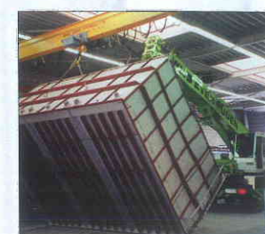
42 m 3 bindmiddelentank voor een lakverffabrikant.
