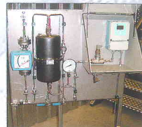
Anti-schuim doseerinstallatie voor de chemische industrie
